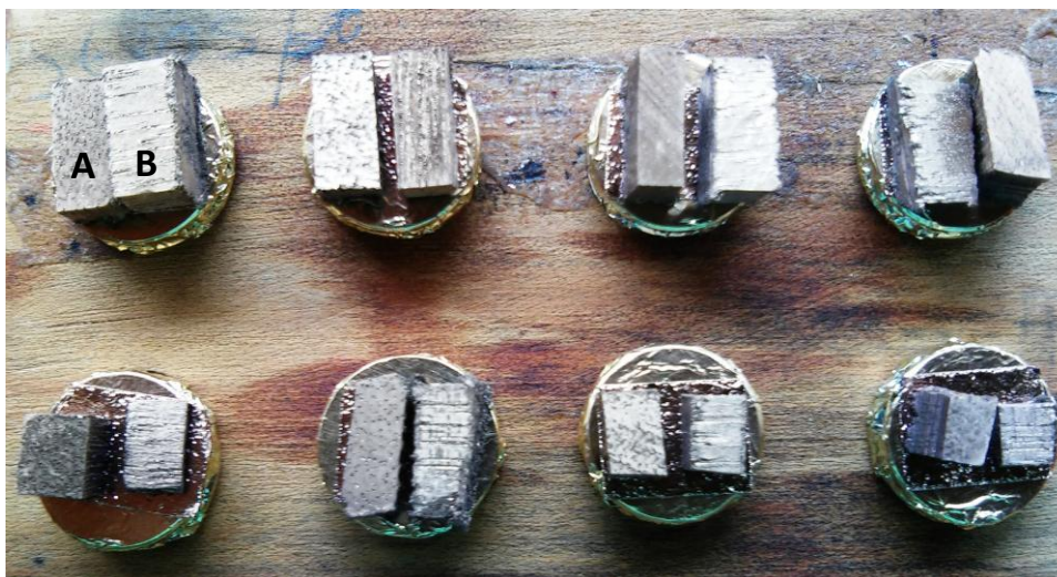
Figura 1 – Amostras orientadas nos planos transversal (A) e radial (B) preparadas para as análises anatômicas no microscópio eletrônico de varredura
