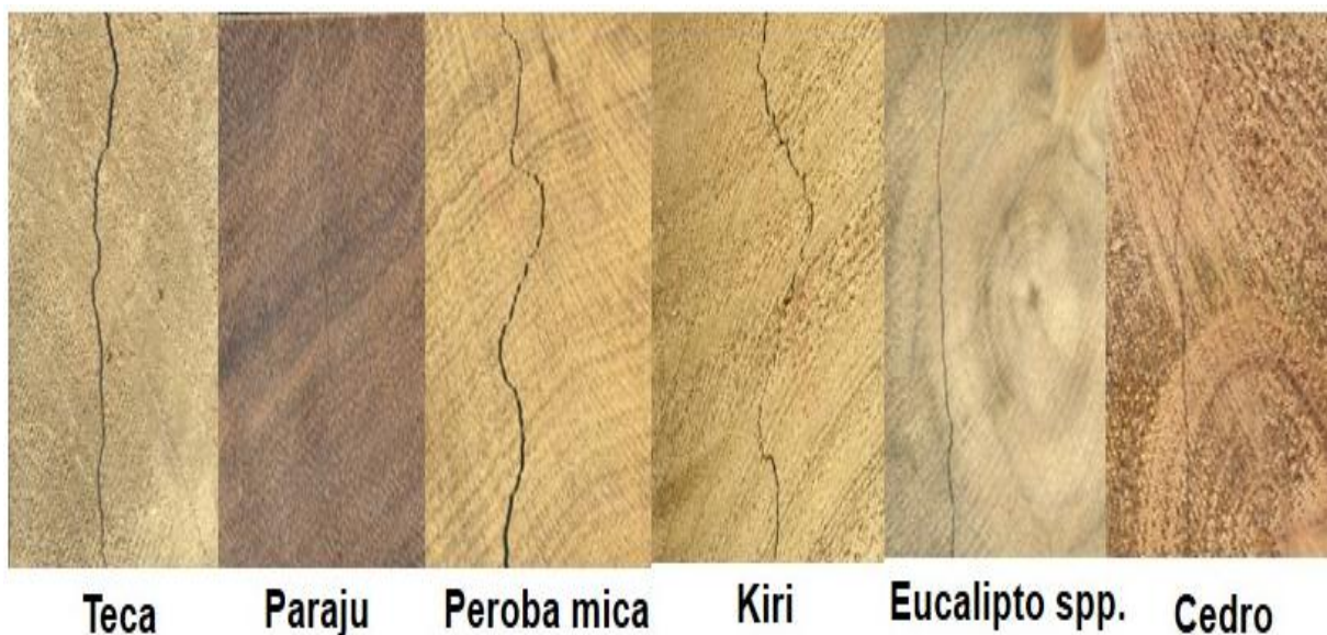
Figura 2. Padrões de grã das madeiras de peroba mica, kiri, paraju, cedro, eucalipto spp., e teca
