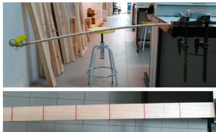
Figura 2. Metodología seguida para calcular el módulo de elasticidad a partir del periodo
