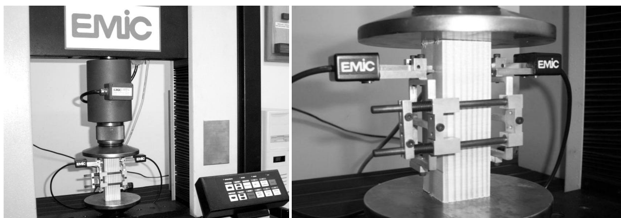
Figura 2. Execução do ensaio de compressão paralela nos corpos-de-prova longitudinais. a) vista geral do equipamento; b) detalhe do acoplamento do clip-gage.
