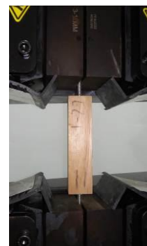
Figura 5. Ensaio de tração axial. Fonte: Autor
