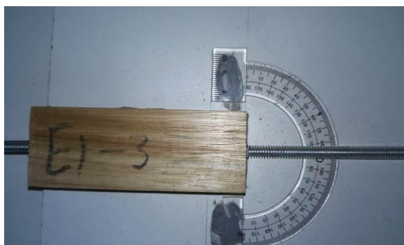
Figura 4. Medição da inclinação das barras. Fonte: Autor
