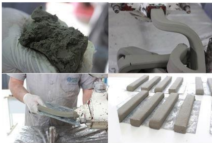
Figura 5. Aspecto da massa com nanofibrilas após mistura e características de uma extrusão bem sucedida
