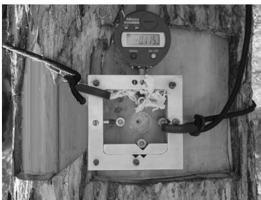
Figura 1 – Extensômetro usado na medição da deformação residual longitudinal (DRL)
