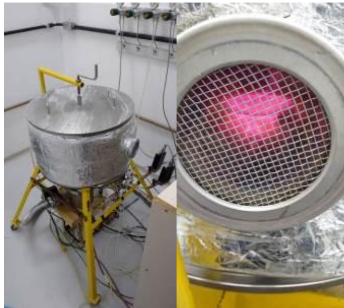
Figura 1. Reator de plasma a frio desenvolvido na Embrapa Florestas com detalhe da descarga luminescente.
