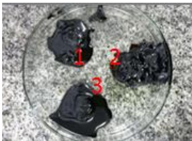
Figura 2: Solubilidade da lignina Kraft em álcool, em diferentes proporções de álcool:lignina, onde: 1 = 1:1; 2 = 1,5:2; e 3 = 1:2.
