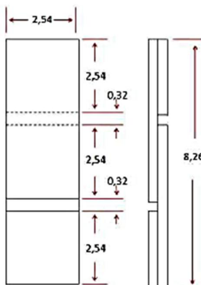
Figura 1. Representação do corpo-de-prova utilizado para o teste mecânico de cisalhamento. Fonte: DIAS, 2014 (adaptado de ASTM D-2339 2008 (2011)).
