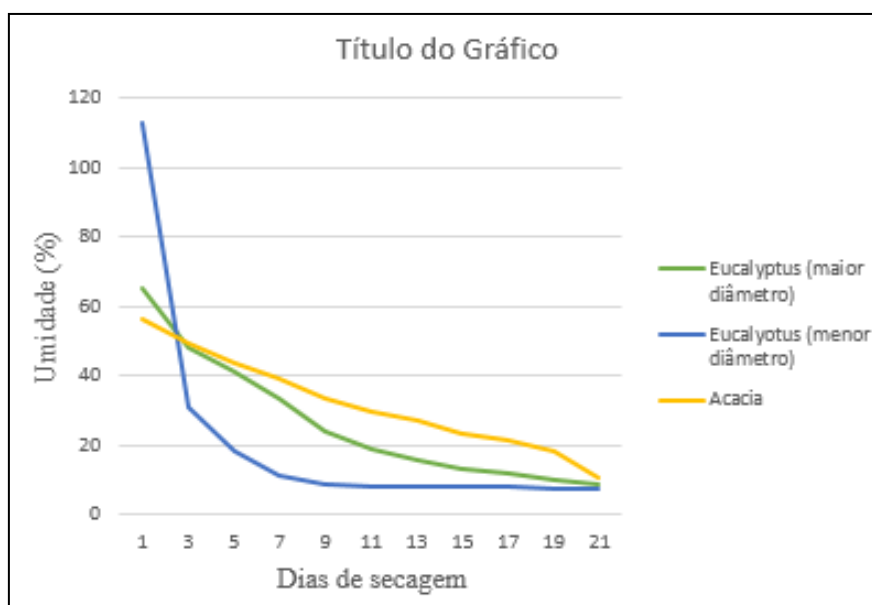
Gráfico 6. Curva de secagem dos discos de Eucalyptus e de Acacia em função dos dias de secagem.
