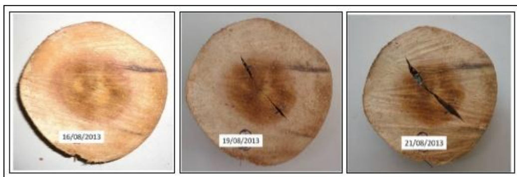
Figura 3. Evolução da abertura das rachas do disco de nove cm de diâmetro (DE9)
