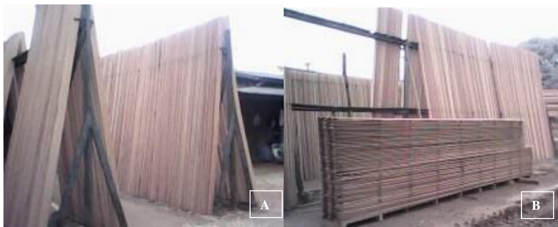
Figura 2-A: Material em pente de estocagem disposto em ângulo de 45 ^{\circ} . 2-B: Material disposto para secagem a 90 ^{\circ} em relação ao solo.
