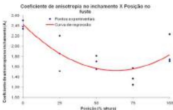
Fig. 1: Curva de regressão obtida para o coeficiente de anisotropia no inchamento,
