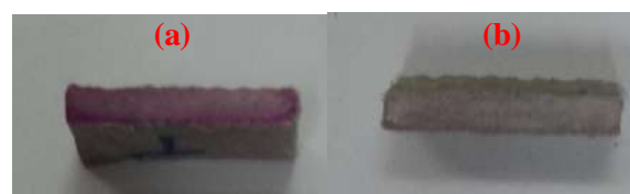
Fig. 1: Aplicação de fenolftaleína na superfície das amostras. a) Cura sem carbonatação. b) Cura com carbonatação.
