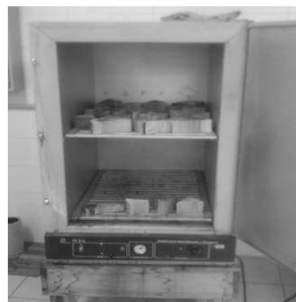
Fig. 2: Cunhas secas em estufa 105°C. (Fonte: autor, 2013).
