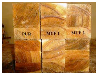
Fig. 2: Aspecto dos corpos de prova após realização do ensaio de delaminação sem descolamento das linhas de cola. (Fonte: FRANÇA, 2013).
