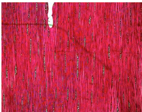
Figura 3: Foto microscópica da madeira do galho de Acacia mangium , corte tangencial.
