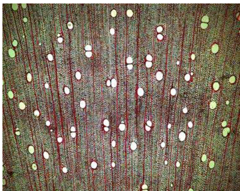
Figura 1: Foto microscópica da madeira do galho de Acacia mangium , plano transversal.
