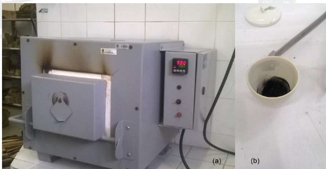
Figura 2. Forno Mufla utilizado nas análises (a) e exemplo de amostra após a volatilização (b).
