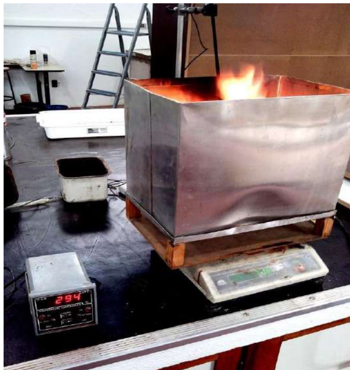
Figura 2: Aparato utilizado para o teste de combustibilidade (Fonte: Scatolino et al. 2014).
