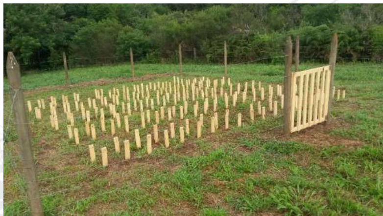
Figura 1. Campo de apodrecimento instalado na Área Experimental Florestal da UFSC.
