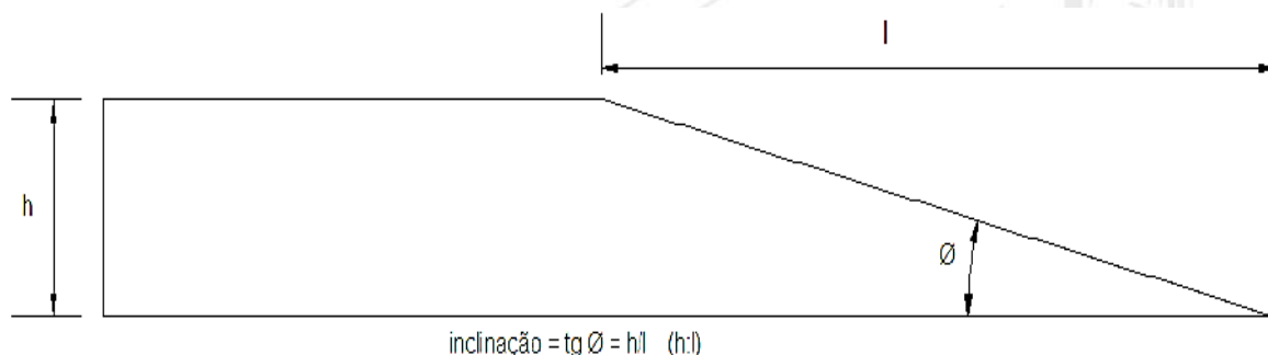
Figura 1. Inclinação das emendas biseladas de acordo com a espessura da peça (h) e o comprimento da emenda (l)
