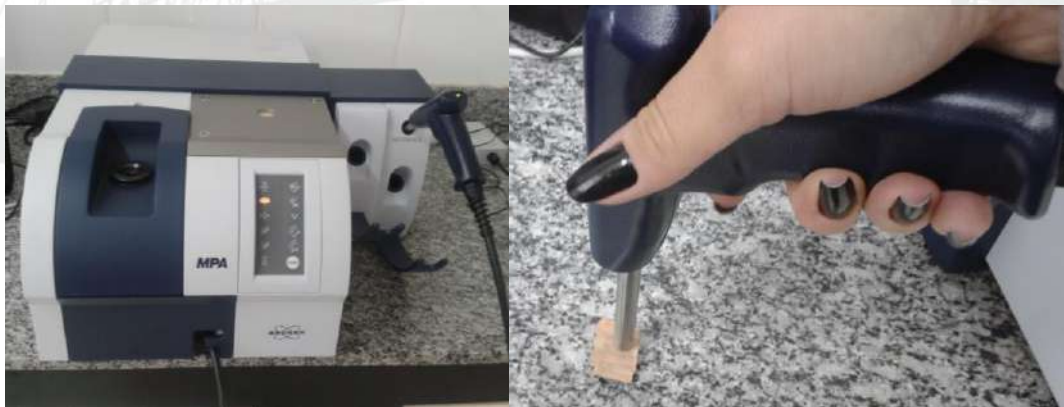
Figura 1. Espectrômetro da marca Bruker (A) e via de aquisição fibra ótica (B) utilizada na aquisição dos espectros.
