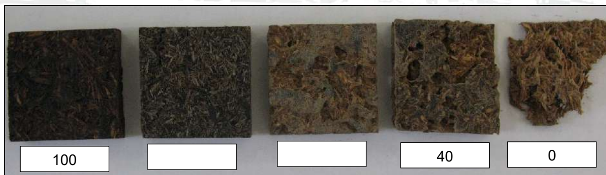
Figura 1. Notas atribuídas aos corpos-de-prova em função da deterioração.
