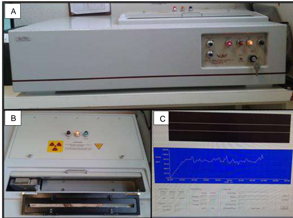
Figura 3. Obtenção dos perfis de densidade. (A, B) equipamento de Raios X QTRS-01X com o suporte metálico e encaixe com a amostra do lenho no compartimento de análise; (C) seção transversal do lenho e perfil de densidade aparente no monitor.
