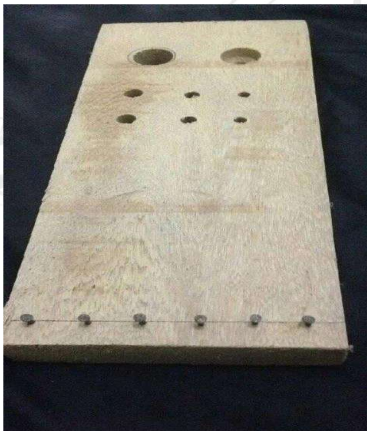
Figura 10. Análise do teste de fendilhamento por pregos no corpo de prova 3.
