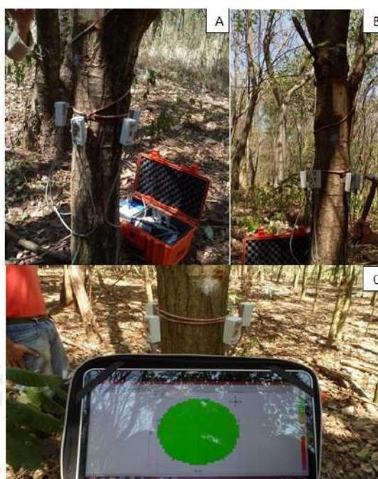
Figura 1. Realização da tomografia de impulso. (A) Instalação dos sensores; (B) geração de impulsos através do martelo; (C) imagem 2D representando o tronco de um indivíduo de Cedrela fissilis Vell.
