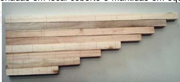
Figura 1. Esquema de corpos de prova de ensaios de flexão. Fonte: O autor (2014)
