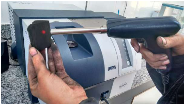
Figura 1. Aquisição espectral de amostra de carvão utilizando fibra ótica. Fonte: Do autor (2017)
