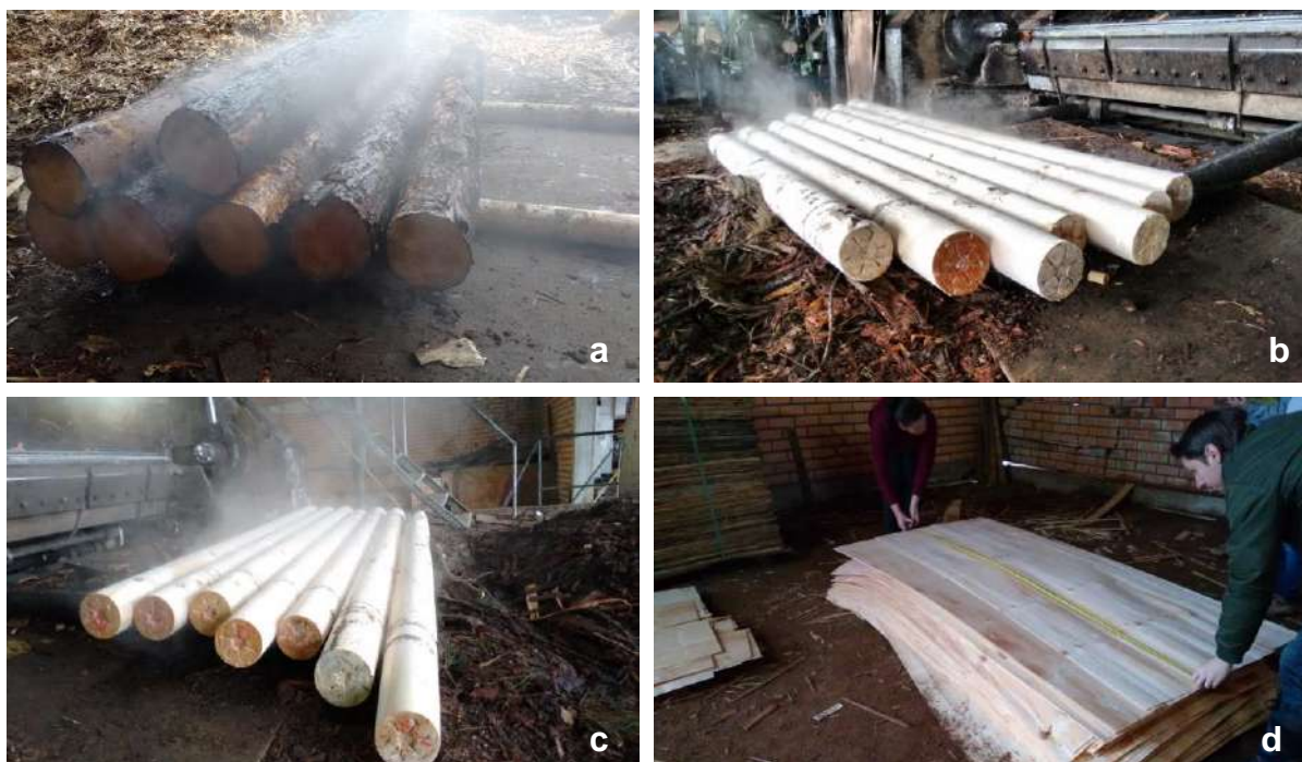
Figura 1. Etapas do processo de avaliação do rendimento em laminação. (a) Toras após o processo de cozimento em tanques de vapor, (b) Toras após o desenrolamento até a forma cilíndrica, (c) rolo resto obtido ao fim da laminação, (d) mensuração das dimensões das lâminas.
