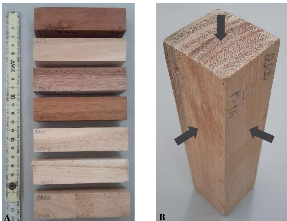
Figura 1. Amostras das sete espécies estudadas (A) orientadas para leitura no espectrômetro nos três planos anatômicos (B)
