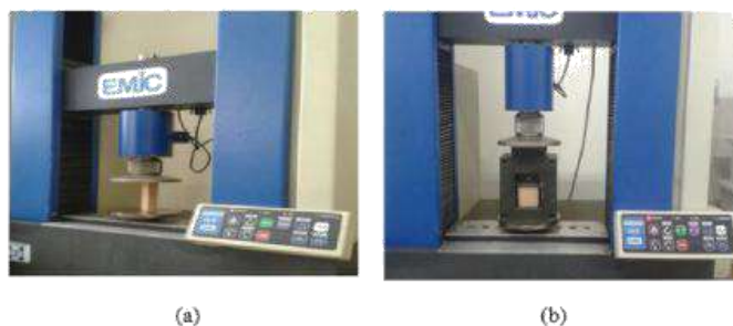
Figura 2. Metodologia adotada para os ensaios. (a) fotografia do método utilizado para o ensaio de compressão paralela. (b) fotografia do método utilizado para o ensaio de cisalhamento.
