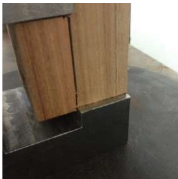
Figura 2. Cizallamiento en la línea de pega Fuente: Elaboración propia
