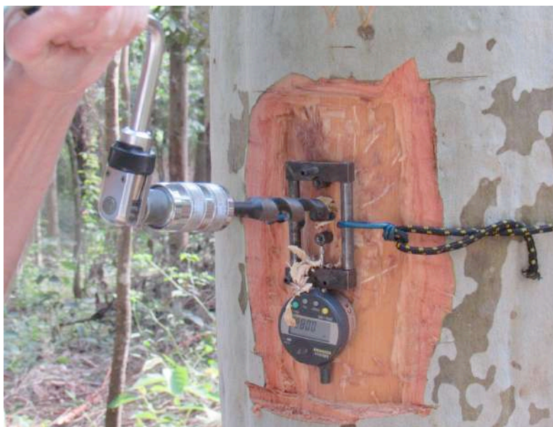
Figura 1. Extensômetro utilizado na mensuração das deformações residuais longitudinais (DRL).
