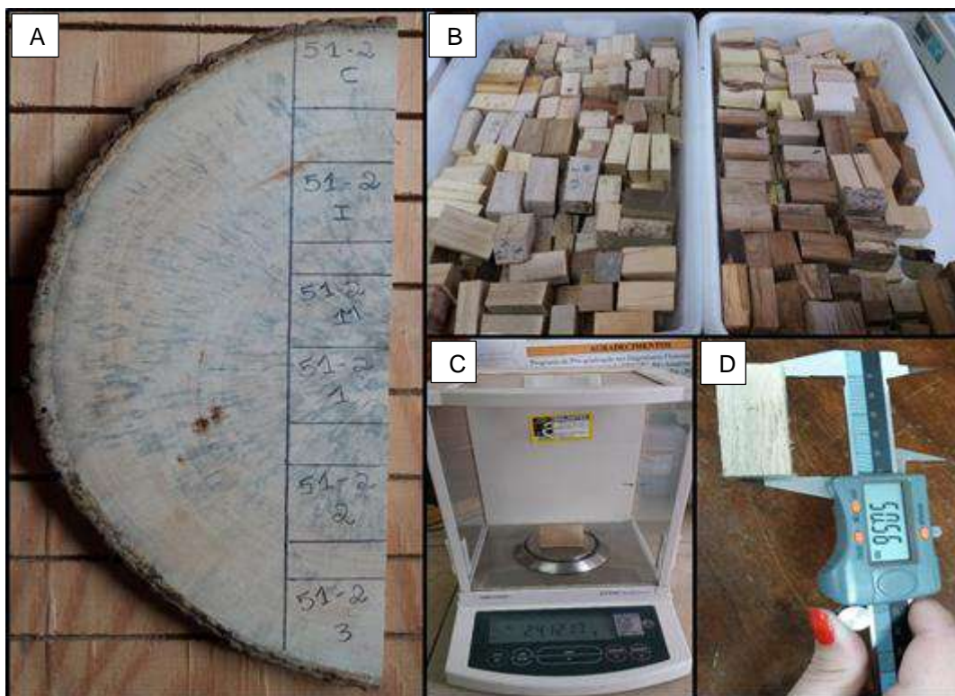
Figura 4. Obtenção da densidade aparente pelo método estereométrico. (A, B) Corpos-de-prova; (C) Obtenção da massa com balança de precisão; (D) Obtenção do volume pelas medidas de todas as dimensões do corpo de prova com auxílio de paquímetro.
