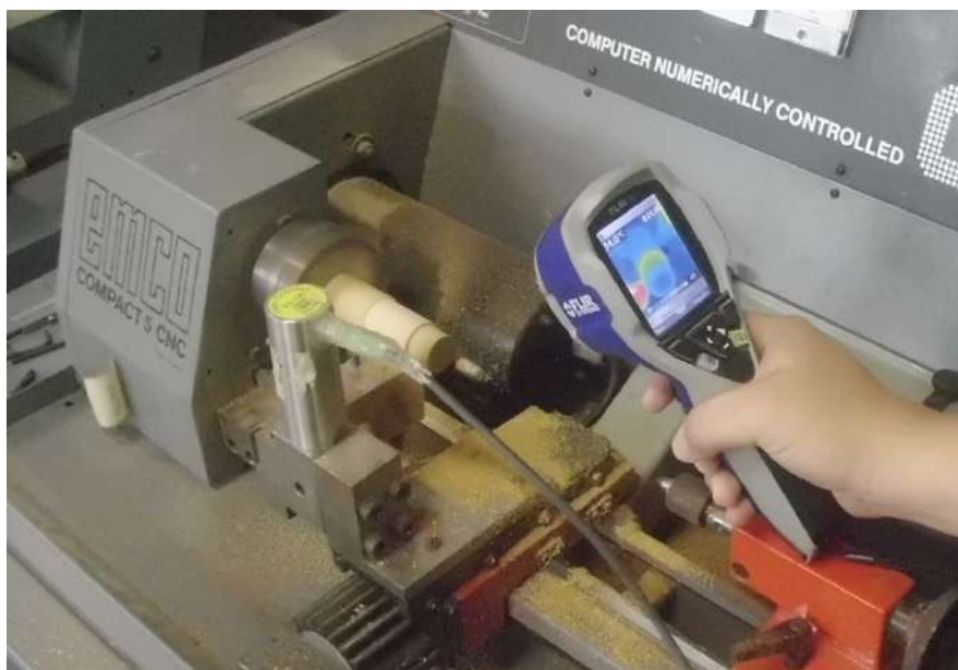
Figura 1 - Câmera termográfica utilizada para aquisição da temperatura. Fonte: Autor.
