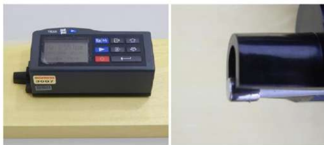
Figura 3. Instrumento de medição da rugosidade, empregado para medição do acabamento superficial das amostras.
