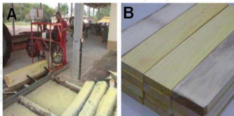
Figura 1. (A) Desdobro primário sendo realizado com auxílio de serra-fita horizontal portátil; e (B) corpos de prova utilizados.
