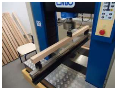
Figura 2. Realização do ensaio mecânico de um corpo de prova flexão estática.
